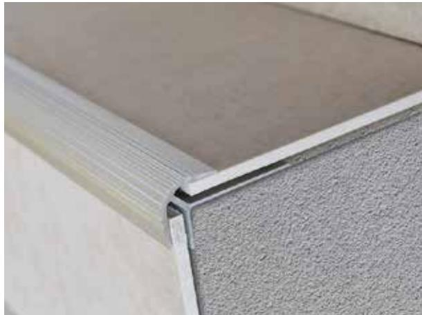
Das STAIRTEC SVT 50 AS-Profil ist eine Treppenkante für LVT-Böden mit einer Dicke von 5 mm und einer Anti-Rutsch-Funktion. Es schützt die Stufenkante vor Stößen und mechanischen Stößen. Die SVT-Treppenkante ist so konzipiert, dass sie vor dem Verlegen der Abdeckung angebracht werden kann, und ihre spezielle Rändelkurve garantiert eine hohe Rutschfestigkeit. Minimales und modernes Design, ideal für private und gewerbliche Anwendungen.
